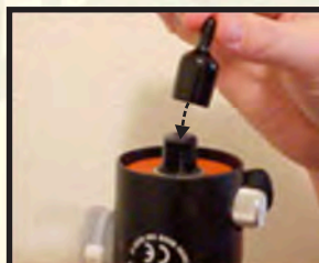
Proteggere il filetto esposto dell'erogatore
