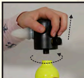
Scaricare l'aria, quindi ruotare l'erogatore in senso orario per svitarlo
